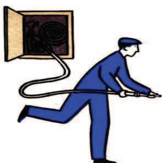
Otwórz szafkę hydrantową
